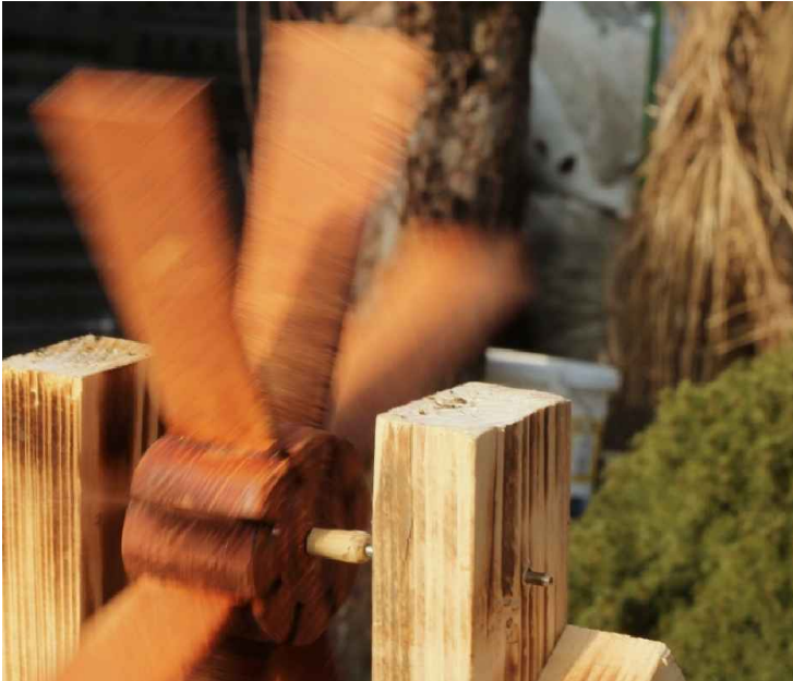
3 - Dřevěný mlýnek lopatkový Ø obvodu lopatek 1,0 m, zabíráno do dna, celodřevěná konstrukce, válec vybaven dynamem na napájení LED osvětlení mostku, doplněno o dřevěné klapátko jedné otočky
